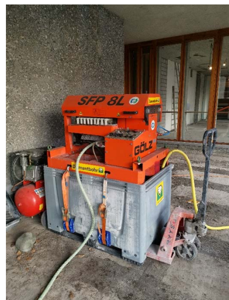
Das Bohr- und Schneidwasser wird gesammelt und mit unserer mobilen Schlammfilterpresse umweltgerecht gereinigt und abgeleitet.
