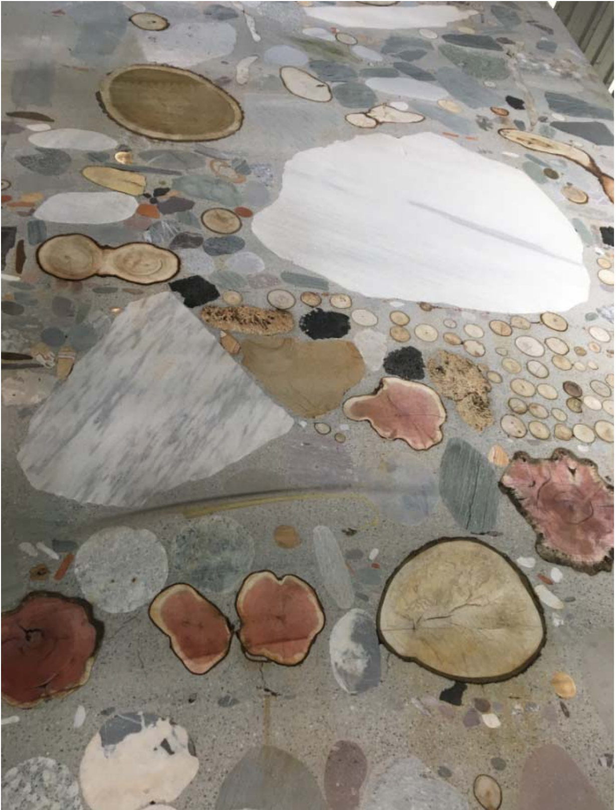
Detail zur Oberfläche vom ersten Seilschnitt (Marmor und Holz)
